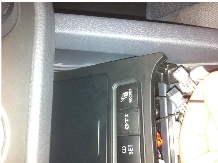
Débrancher les fiches ESP et de contrôle de PRESSION (dans mon cas).
