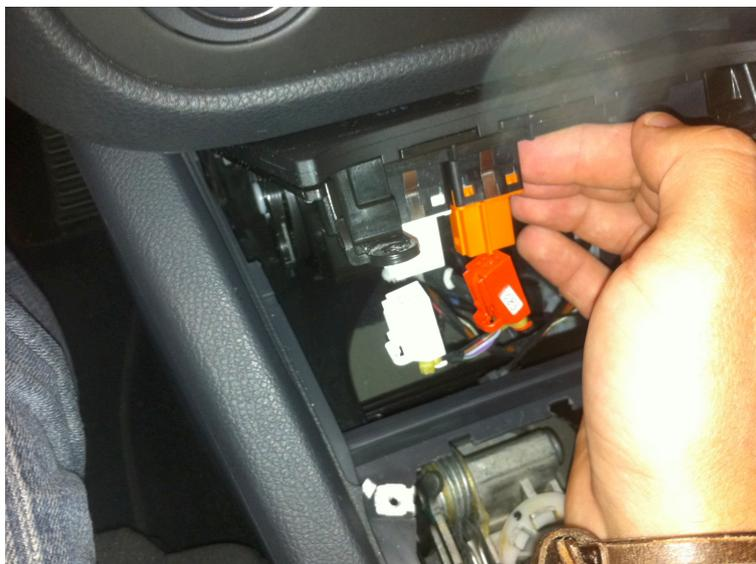
Placer les fiches femelles des boutons d'ornement dans les slots à la place des fiches ESP et de contrôle de PRESSION. (slots blanc et orange) Il y a un sens de montage. Le fil noir et blanc doit passer sur la droite du bouton.
