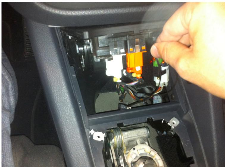
Pour démonter les boutons vierges, il suffit de pincer les ergots et pousser les boutons vers le haut.
